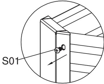
Ersetzen Sie an den unten markierten Stellen S01 durch S02 (6 Stück insgesamt)
