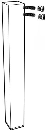
Schraubenmuttern lösen dann die Gewindestangen der Beine in die gekennzeichneten Positionen einführen und mit den Schraubenmuttern befestigen
