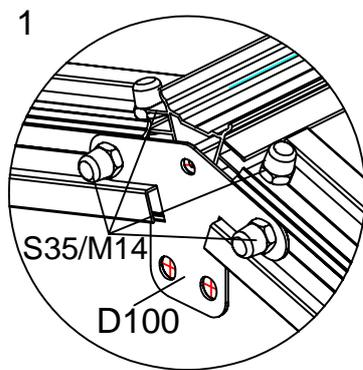
Montieren Sie L01B an L01A, mit der Platte D99 und S35 & M14.
