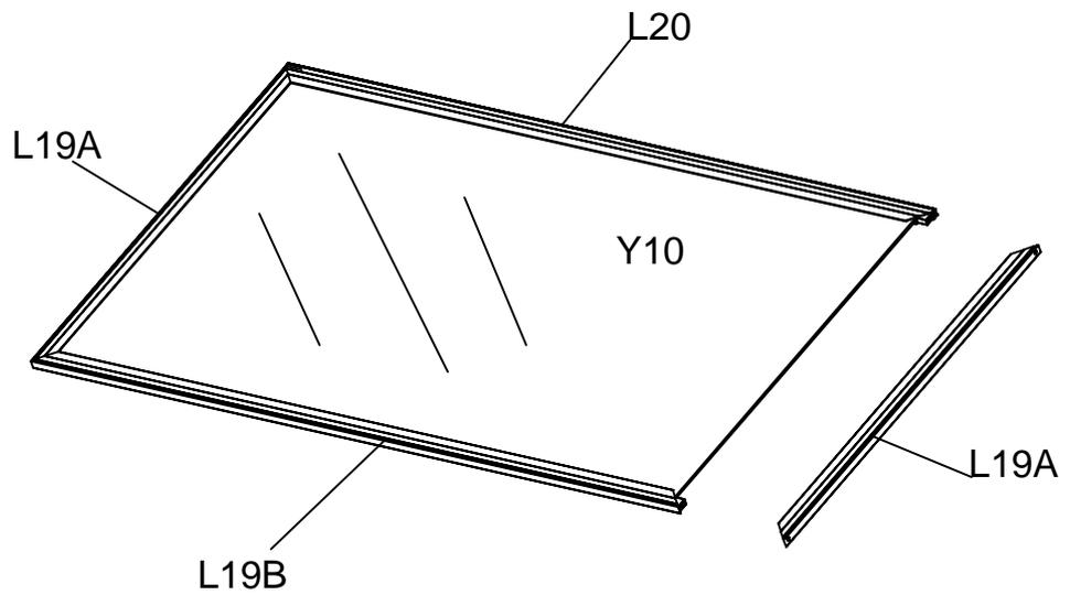
Befestigen Sie L19A an L20 und L19B mit Z15, und setzen Sie dann die Platte Y10 in ihre Position ein.
