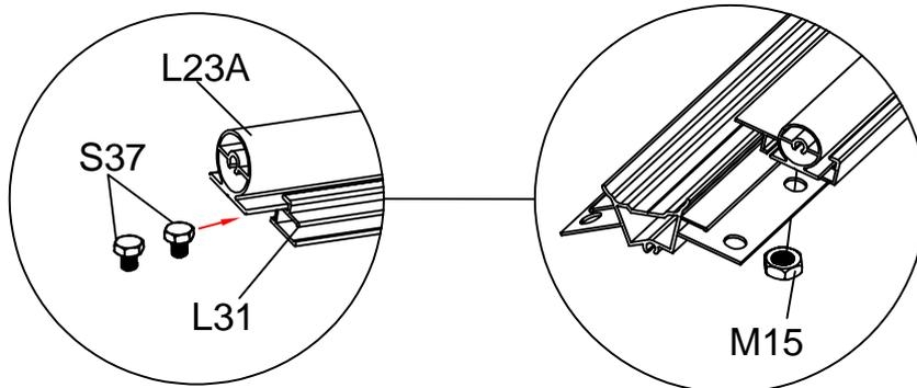
Schieben Sie 2 \* S37 in den Kanal von L31, um es mit M15 an L06 zu befestigen.
