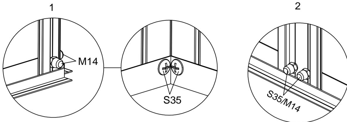
Befestigen Sie alle vertikalen Elemente mit S35 & M14.
