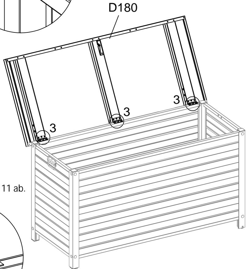
Befestigen Sie die Abdeckplatte D180 an der Seitenwand K3, mit S15.
