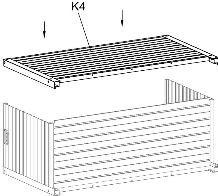
Befestigen Sie eine weitere Seitenwand K4 an den Enden der Wände K1, K2 und der Bodenplatte K5 mit Z30. Vergewissern Sie sich, dass sie vollständig in Position sind.
