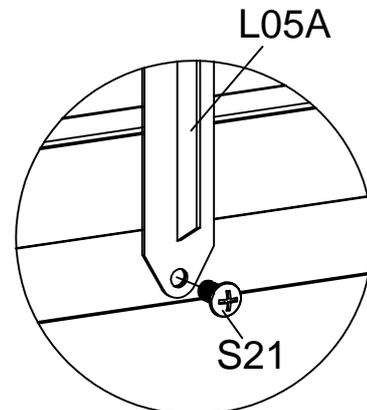
Befestigen Sie die Stützstange L05A mit S21.
