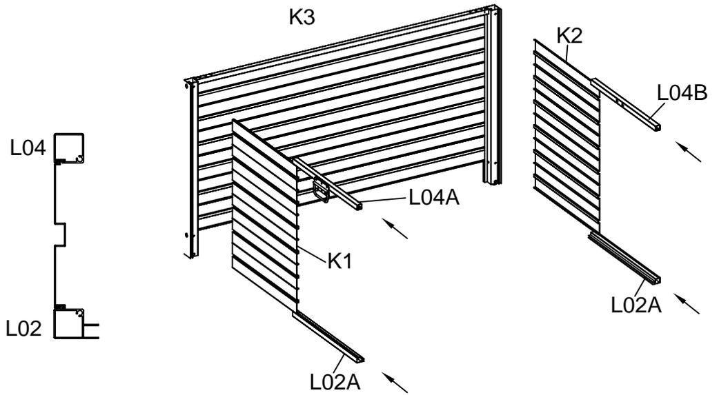
1. Setzen Sie die Endplatte K1 in die Führungsschiene von L04A und L02A ein und befestigen Sie sie dann mit einem Ende der Seitenplatte K3 mit Z30.
