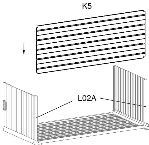
3. Legen Sie die Kissenbox hin und setzen Sie die Bodenplatte K5 in die Führungsschiene von L02A ein.
